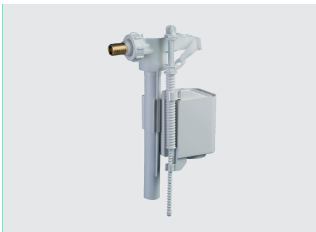
▲ Zawór napełniający HDV, G 3/8, króciec mosiężny, wlot z boku
